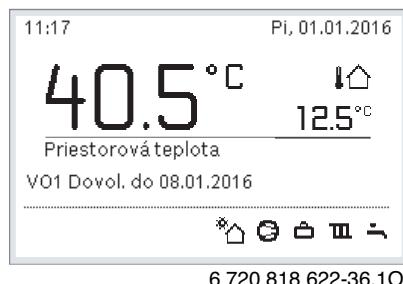
Ak sú nainštalované 2 alebo viaceré vykurovacie okruhy, tak je nutné pred prerušením dovolenkového programu zvoliť v standardnom zobrazení príslušný vykurovací okruh.
