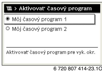
Ovládací panel pracuje v automatickom režime so zvoleným časovým programom. Ak sú nainštalované 2 alebo viac vykurovacích okruhov, toto nastavenie sa vzťahuje len na zvolený vykurovací okruh.
